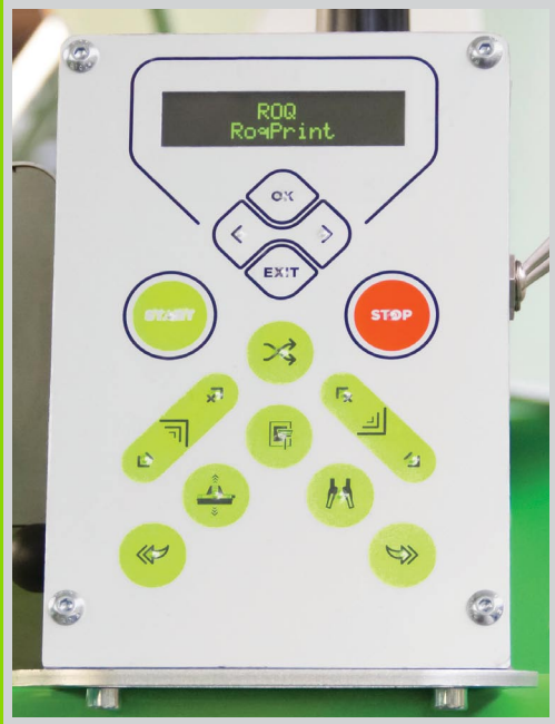
:: BASKI CONTROL PANELİ : KALIBIN HAREKET VE POZİSYONU; KALIP POZİSYONUN HAFİZASI VE KAYDEDİLMESİ
